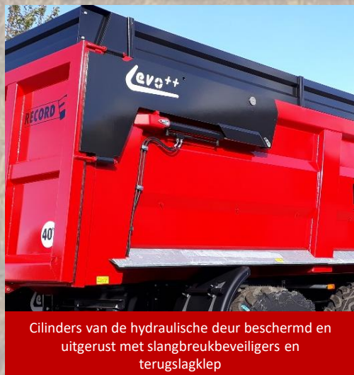
Vrije hoogte onder de hydraulische deur indien volledig geopend: 2750 mm
