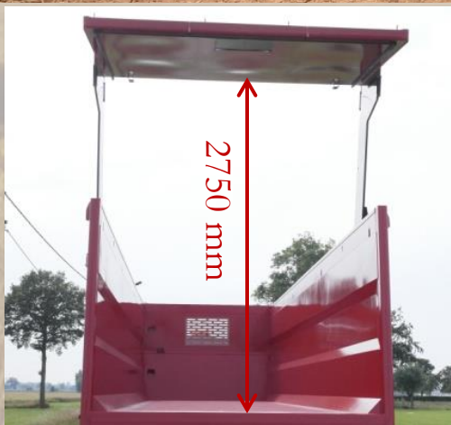
Vrije hoogte onder de hydraulische deur indien volledig geopend: 2750 mm
