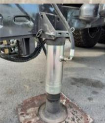
Le timon est également équipé de série d'un cric hydraulique à partir du V 1000. Celui-ci est relié au tracteur par le tuyau hydraulique. Cela peut également être connecté à une pompe à main.
