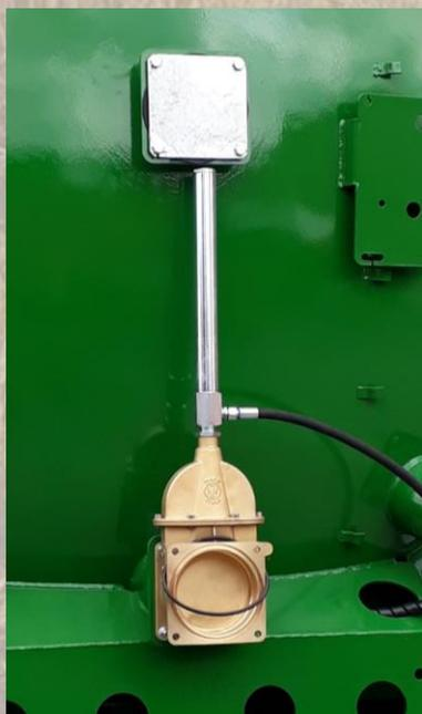
La tonne est équipée de série d'une vanne en laiton de 6" à l'arrière de la tonne pour faire fonctionner l'éparpilleur. Cette vanne est actionnée par un vérin hydraulique à simple effet qui fonctionne avec un ressort interne. Si un injecteur est utilisé, une vanne supplémentaire peut être montée au milieu de la tonne pour l'alimentation de l'injecteur. Celui-ci est ensuite équipé d'une vanne hydraulique à trois voies où l'on peut basculer entre les deux vannes.
