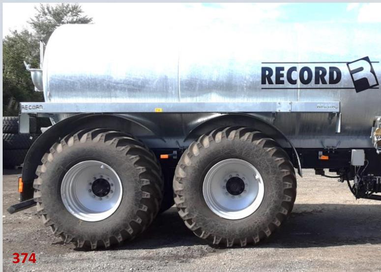
Si les pneus sont montés avec un grand diamètre et une grande largeur, les roues doivent être encastrer. Cela permet de rester dans la largeur légale de 3 mètres avec des pneus jusqu'à 1050 mm de large. Ceci avec ou sans essieux directeurs. Ceci est également possible avec les tonnes vergers pour atteindre une largeur totale de 1500 mm.
