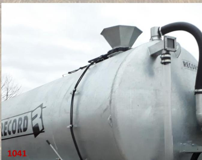
Pour les gros débit plus élevé, un cône de remplissage supérieure de 12" est recommandé. Celui-ci est ensuite équipé d'un cône de décharge galvanisé.
