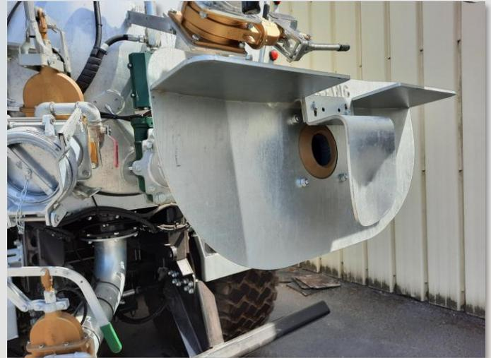
En option, un éparpilleur Vogelsang peut être monté. L'avantage est que l'épandage se fait directement vers le sol. Cela permet de travailler jusqu'au bord de la parcelle et de faire une épandage plus précis. En coopération avec une pompe volumétrique à contrôle de débit proportionnel, on peut même ajuster la largeur d'épandage.
