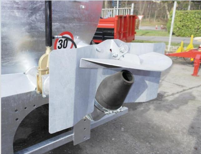
Chaque tonne est équipé de série d'un éparpilleur exact de 6" avec une lame large. Le lisier est poussé vers le haut dans la buse et distribué en grande largeur par la palette d'épandage.
