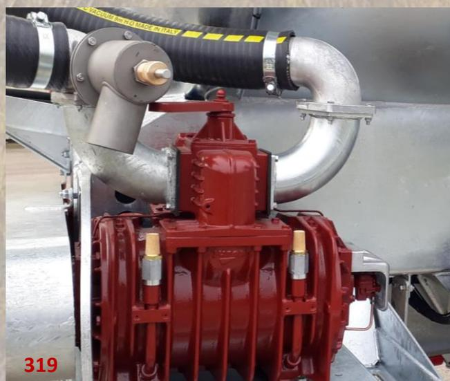
Si vous souhaitez contrôler la pression de sortie par exemple pour travailler avec un injecteur, il est recommandé de monter la soupape de surpression 2" en Inox. La surpression peut être contrôlée en continu et la pompe reste à une pression continue pendant le processus d'épandage. Cela profite également à la durée de vie de la pompe
