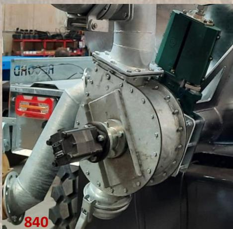
Si un débit important doit être pompé, on peut également travailler avec un turbo compresseur. Cela fonctionne selon le même principe que le turbo remplisseur. Cela peut être utilisé, par exemple, pour alimenter des injecteurs des canons d'irrigation. Celui-ci est également entraîné hydrauliquement et est situé sur la sortie de la tonne.
