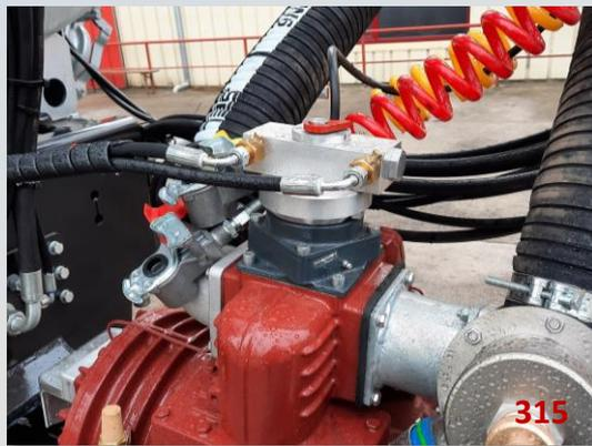
Les pompes à vide sont équipées de série d'un levier pour inverser manuellement l'aspiration/soufflage de la pompe. Cela peut également être fait hydrauliquement en option. Cette option est particulièrement intéressante lors de l'utilisation d'un bras d'aspiration ou si la pompe n'est pas facilement accessible. C'est aussi possible de l'inclure également dans la commande électrique ou la commande Isobus.
