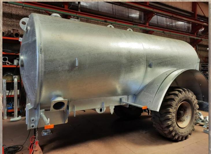
Record propose une large gamme de tonnes à lisier ainsi qu'une gamme encore plus large d'options. Tous les tonnes sont entièrement galvanisés à chaud à l'intérieur et à l'extérieur, comme toutes les pièces connectées à la tonne. Toute la gamme Record est construite selon les normes Européennes (Règlement 167/2013) et est livrée avec un COC valide. Les tonneaux sont divisés en 3 catégories, en fonction du nombre d'essieux. Les tailles spécifiées sont le contenu de la tonne net.
