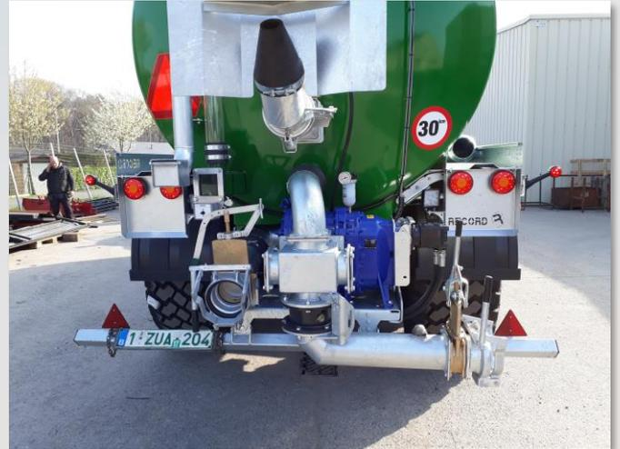
Les pompes volumétriques fonctionnent avec 2 rotors à lobes. La rotation crée un vide de sorte que le lisier est aspiré par la pompe. Le gros avantage est que ces pompes peuvent traiter les matériaux très rapidement et que le débit est réglable. Ceux-ci sont donc adaptés pour aspirer du lisier jusqu'à 4 mètres de profondeur et avec très peu de perte de pression avec des tuyaux plus longs. Étant donné que le lisier doit passer par la pompe, il s'agit d'un assemblage plus complexe sur la tonne.
