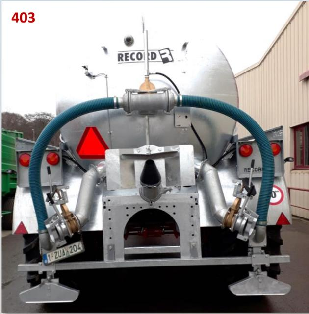
Le kit de montage avec 2 buses est monté sur le pare-chocs de la tonne à l'arrière et est relié à une vanne centrale supplémentaire. Ces buses sont utilisées pour 2 applications.
