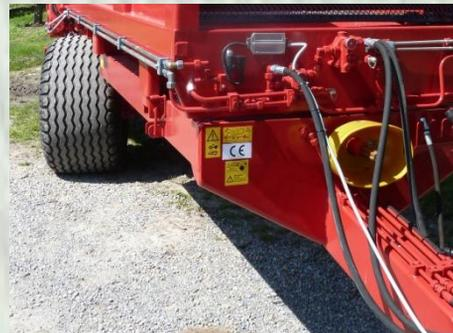
**Essieu directionnel hydraulique manuel**
