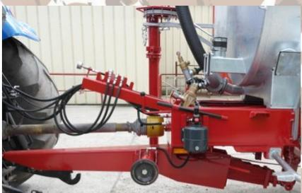
Suspension de timon à lames ou hydraulique
