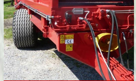
Handbediende gedwongen hydraulische sturing
