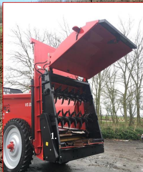
1. Breedstrooier uitvoering op VS 355 met 2 horizontale walsen, 2 horizontale strooischijven en hydraulische deur achter de molen (optie)
