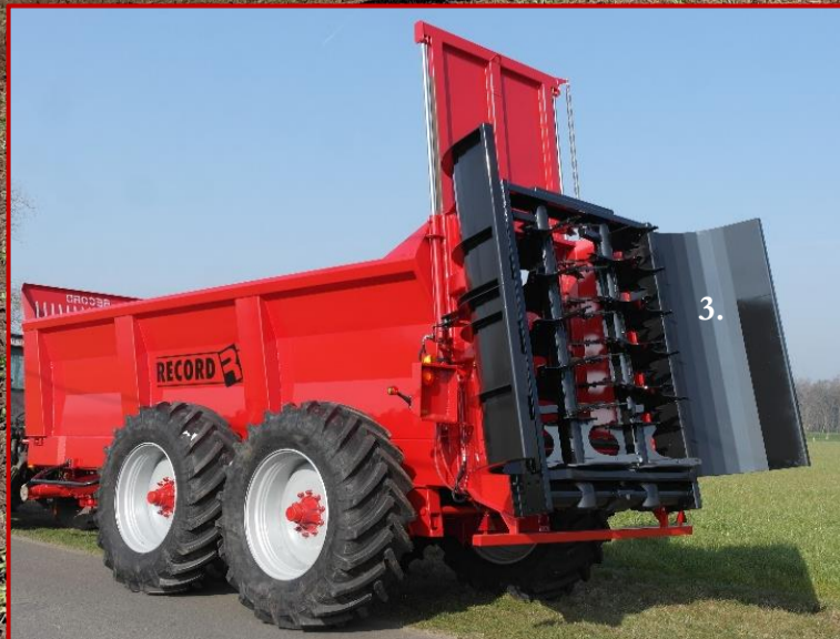
3. Strooibegrenzing links en rechts (optie) 4. De conisch ontworpen kast
