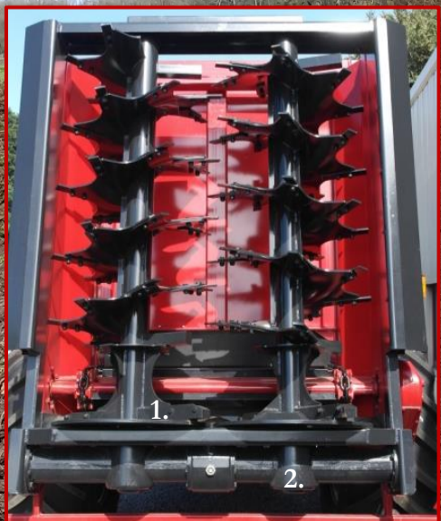
1. 2 Verticale walsen Ø 870 met verwisselbare Hardox beitels 2. De aanrijfkast van de strooiwalsen
